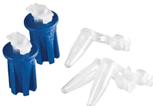
Адаптер для ПЦР-пробирок объемом 0,2 мл > Лучший выбор для осаждения ПЦР в пробирках после подготовки реакции. Адаптер подходит к любому ротору Eppendorf для пробирок объемом 1,5/2,0 мкл
