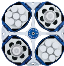
Универсальный адаптер 3 Для установки конических пробирок 50 мл и колб 250 мл.
