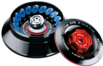
Ротор FA-45-18-11 > для 18 пробирок 1,5/2,0 мл поставляется с уникальной аэрозоленепроницаемой крышкой QuickLock для быстрого и надежного закрывания
