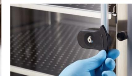
**Простота работы:** Технология магнитных затворов дверей существенно сокращает усилия, необходимые для открывания плотно закрытых дверей. Дверь можно легко открыть, либо потянув на себя двухходовые фиксаторы внутренних дверей, и закрыть ее, либо нажав или повернув фиксаторы. Таким образом, можно отрегулировать механизм в зависимости от привычек пользователя. Также доступна функция усовершенствованной защиты чувствительных клеток от вибрации при открывании или закрывании двери.
