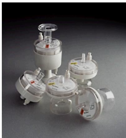
Фильтрующий элемент Миллипак представляет собой фильтр Миллидиск, выполненный не в виде картриджа, а заключенный в неразъемный пластиковый корпус. Фильтры Миллипак выпускаются с размером пор 0,1, 0,22 и 0,45 мкм и с разными входными и выходными патрубками. Пять размеров фильтров площадью от 100 до 1000 см<sup>2</sup> позволяют выбрать оптимальный для процесса. Все фильтры поставляются предварительно стерилизованными, фильтры площадью 500 и
