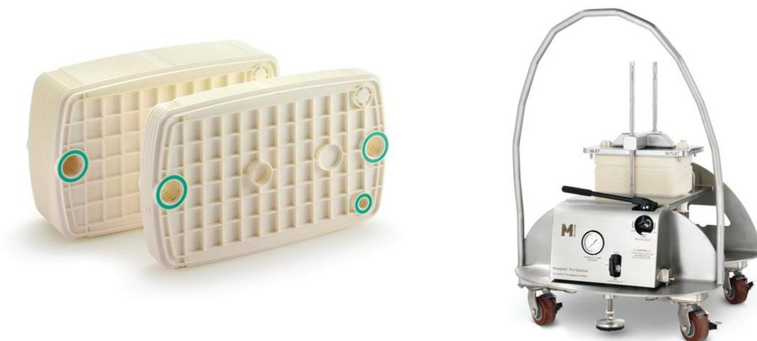
Фильтрующие элементы Магнус разработаны для промышленных производств. Выпускаются в двух исполнениях: 0,51 и 1,53 м<sup>2</sup>. Для фильтроэлементов разработан держатель, позволяющий размещать до 7 кассет. Держатель сконструирован таким образом, что его материал не контактирует с фильтруемой жидкостью.
