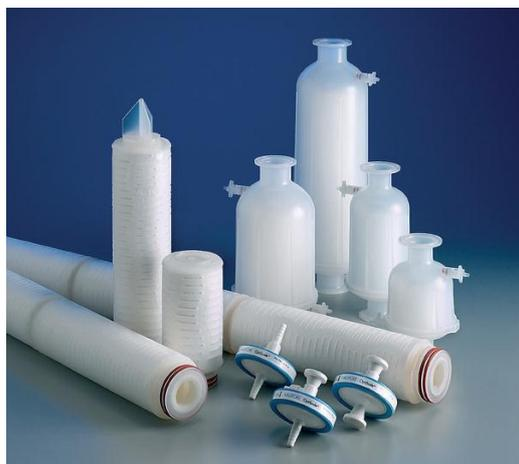
Фильтрующий материал поливинилидендифторид, выпускаемый компанией Миллипор под торговой маркой Durapore (Дюрапор), хорошо зарекомендовал себя при фильтрации жидкостей различной природы. Материал отличается высокой прочностью, низким связыванием белка и минимальной экстрагируемостью. Фильтры выпускаются от небольших лабораторных фильтров Optiscale (Оптискейл) площадью  $14 \text{ см}^2$  до промышленных картриджей площадью  $2 \text{ м}^2$ .
