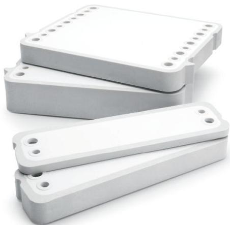
В более жестких по температурным и химическим параметрам условиях могут применяться ультрафильтрационные кассеты Пелликон-3. Их ключевой особенностью является отсутствие клеевых соединений. Кассеты рассчитаны на 50-часовую работу с 0,5N NaOH при 50<sup>0</sup> и с очищенной водой при 80<sup>0</sup>. Кассеты Пелликон-3 выпускаются с пределами отсечения 10 и 30 кД. Исполнение в площадях 88 см<sup>2</sup>, 0,11 м<sup>2</sup>, 0,57 м<sup>2</sup> и 1,14 м<sup>2</sup>. Тип мембраны – только Ultracel.
