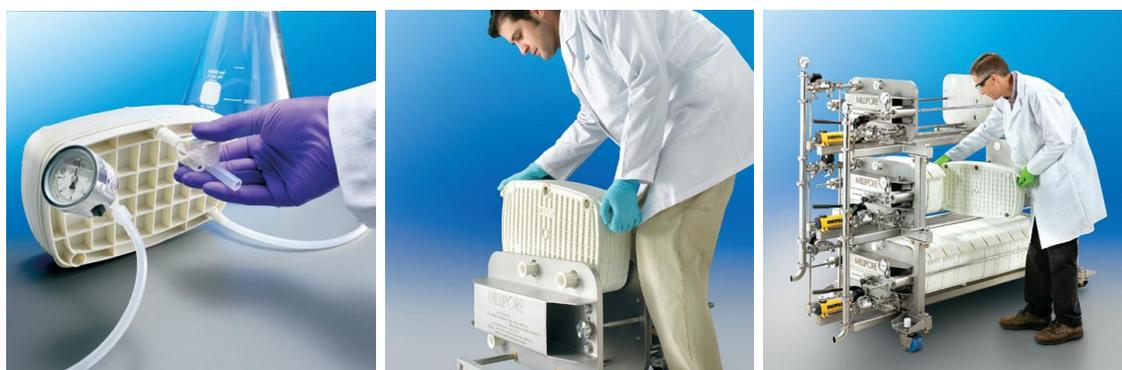
Высокопроизводительные кассеты POD разработаны для осветляющей фильтрации в лабораторных, пилотных и промышленных масштабах. Широкая область применения, от лаборатории до производства, возможна благодаря модульному дизайну системы.
