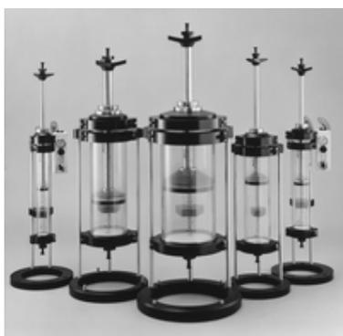
Колонны Vantage S2 разработаны для проведения хроматографических пилотных процессов и наработки небольших серий препаратов в фармацевтике и биотехнологии. Колонны изготовлены из прозрачного пластика, устойчивого к растворителям. Конструкция проста в использовании и сборке. Колонна рассчитана на давление до 3 атм и температуру эксплуатации от 2 до 30<sup>0</sup>С. Подсоединение колонны в линию осуществляется с помощью стандартного санитарного соединения Tri-Clamp ¼”.
