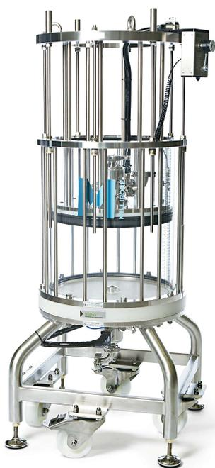
Колонны IsoPak разработаны для промышленных производств. В этих колоннах применяется процесс автоматической загрузки и выгрузки без разборки колонны. Это значительно сокращает время упаковки и распаковки колонны, повышает воспроизводимость процесса и исключает контакт оператора с хроматографическим сорбентом.
