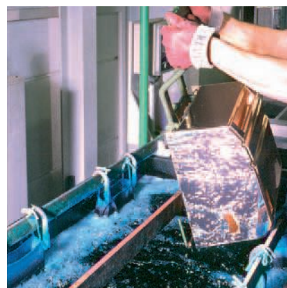
Гальваническое производство: Различные металлы используются для покрытия, например, на детали сантехники
