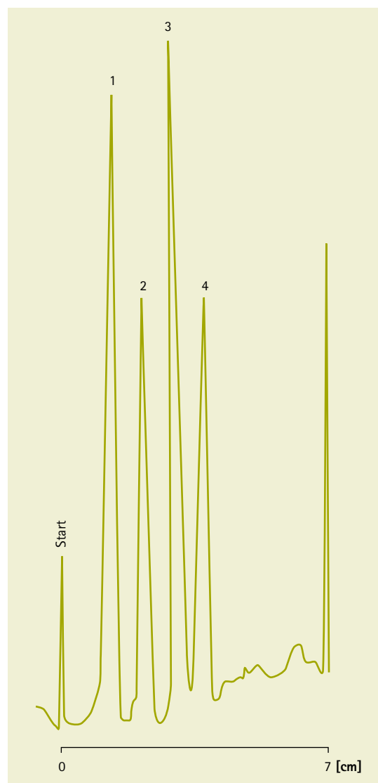
Разделение олигонуклеотидов на ВЭТСХ пластине с NH 2 -модифицированным силикагелем 60
