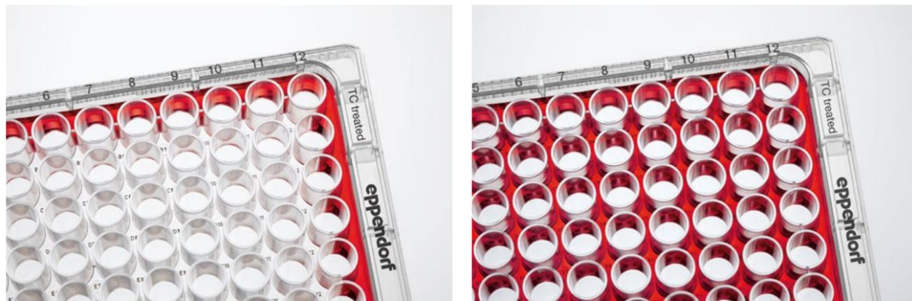
Предотвращение возникновения краевого эффекта благодаря возможности заполнения окружающего края канавки увеличивает количество используемых лунок на 38 %
