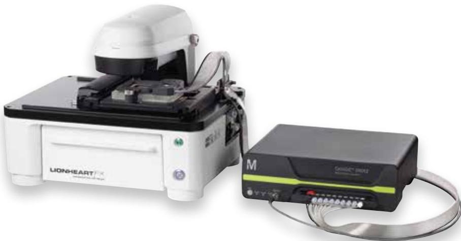
**Система CellASIC® ONIX2 работает в паре с Вашим инвертированным микроскопом, позволяя проводить долгие эксперименты с клеточной перфузией и динамичные “time-lapse” анализы.**
