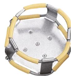
Зажим для колб, целиком выполненный из нержавеющей стали, регулируется при помощи пружин, что позволяет добиться устойчивости при повышенной скорости.
