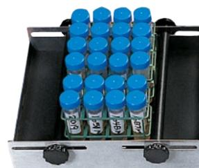
Держатели с помощью регулируемых стержней с мягким покрытием надежно фиксируют емкости.
