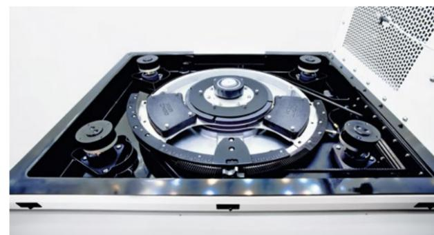
Привод Eppendorf X-Drive с пятью эксцентриковыми точками крепления и регулируемым противовесом гарантирует надежную работу
